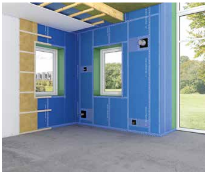
DAFA-folier ska alltid monteras med textsidan vänd mot den uppvärmda delen.
